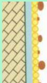
污渍或灰尘落在WILLSTRONG®纳米自洁铝复合板涂层表面,会因为涂层表面的纳米致密结构,使污渍无法吸附或有少量残余,当自然雨水来临时,污渍将被轻松冲洗清除,从而达到自洁的目的。
